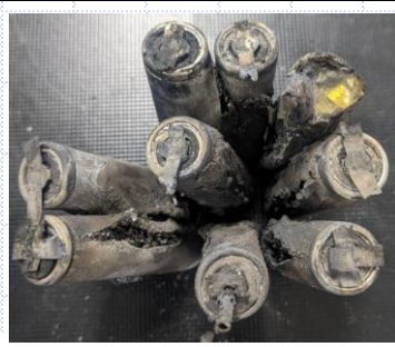
失控燃燒後電池
