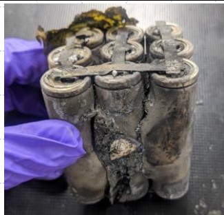
失控燃燒後電池
