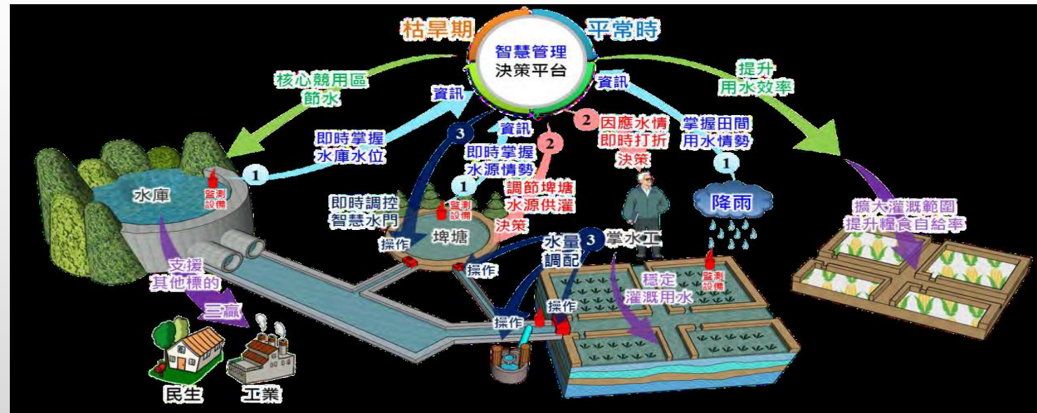
以智慧灌溉系統進行科學化之智慧配水
