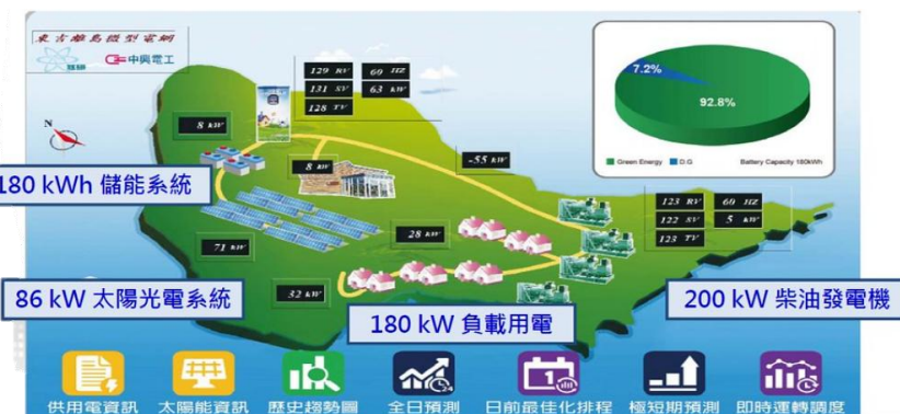
東吉嶼微電網系統架構 (核研所)
